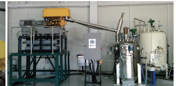
〈초전도 한류기 냉각시스템〉
