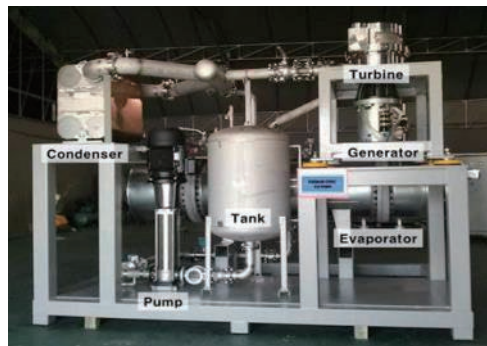
〈폐열회수 발전용 200kW급 ORC 시스템〉
