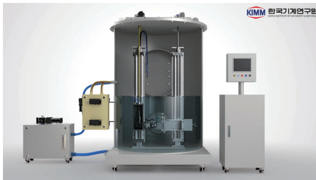
〈수심 10m 이상 모사 환경 및 레이저 가공 수행 모식도〉
