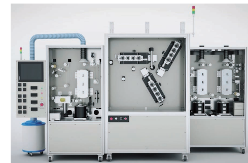
〈섬유형 전극 연속 제조 장비 시스템〉
