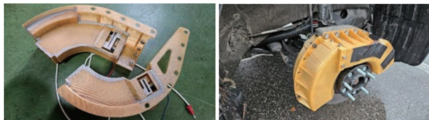
〈브레이크 마모 미세먼지 집진장치 및 실차 장착 모습〉
