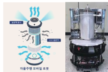
〈자율주행 방역 로봇 개념도 및 개발 시스템〉
