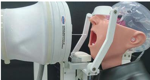
〈비대면 원격 검체채취 로봇 시스템〉
