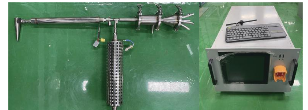
〈굴뚝 고정형 미세먼지(PM2.5, PM10) 연속 측정 장치 : (좌) 희석 샘플링 장치, (우) 제어반〉
