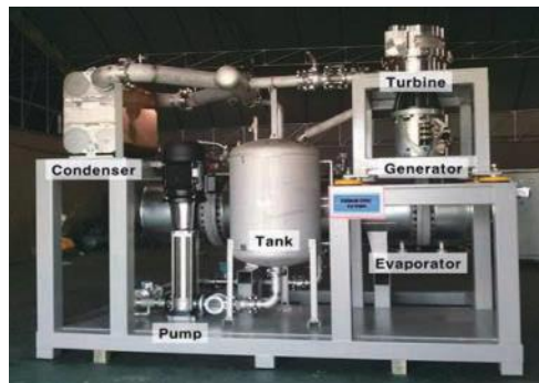
〈폐열회수 발전용 200kW급 ORC 시스템〉
