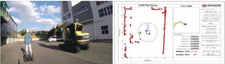
〈마네킹을 이용한 선회 시 충돌 안전제어 실험(좌), 운전자 제공 환경 모니터링 시스템(우)〉
