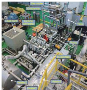
〈폐열회수 발전용 100kW급 초임계 ORC 시스템〉
