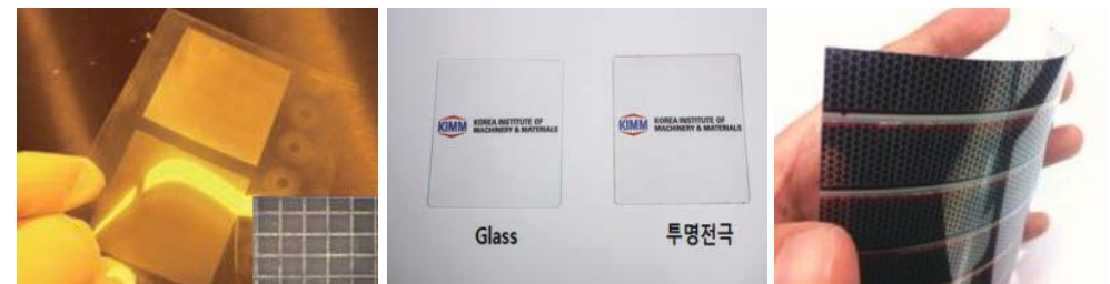
〈투명전극 제작 결과/투명전극필름/유연유기태양전지(응용)〉
