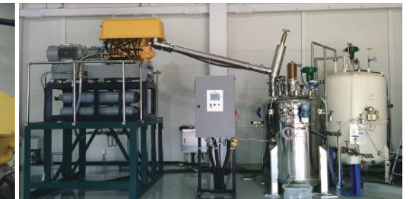
〈초전도 한류기 냉각시스템〉
