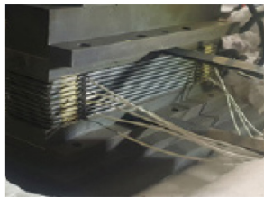
평관형 고체산화물 셀 적용 양방향 고온수전해-연료전지 시스템
