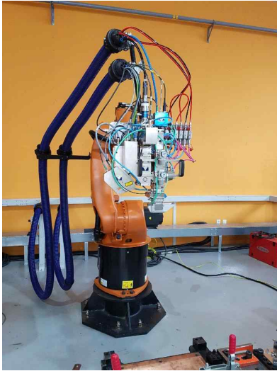
참고자료 3 알루미늄 도어 레이저 용접 스캐너 장치 (사진)
